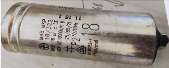
Le condensateur est un composant de forme cylindre de type métallique avec 2 cosses électriques et il est fixé sur un support en plastique (maintenu serré par une rondelle et contre écrou)
