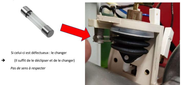
Evitez de toucher les fils noirs soudés sur la platine plastique (pour éviter tout risque électrique ou de dessoudage/accrochage avec les doigts)
