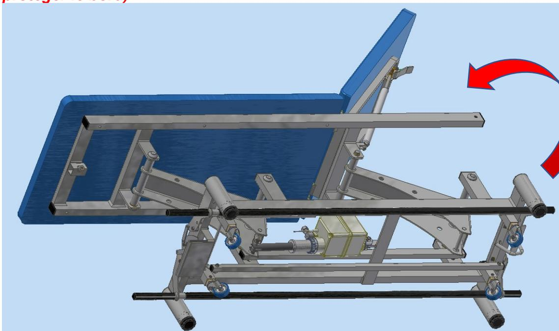
4.1 **Positionner une cale en mousse ou un chiffon sous le vérin** pour amortir le vérin lors de son démontage (et éviter qu'il raye le châssis de la table)
