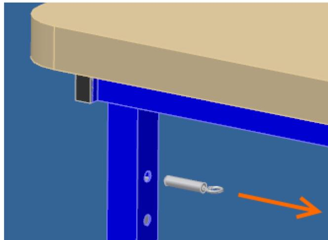
3/ Insérer l'axe goupille dans le trou de réglage adapté à la hauteur que vous souhaitez utiliser la table.
