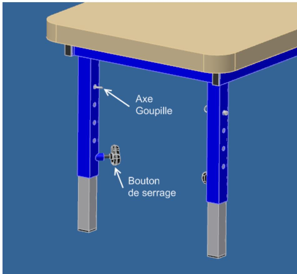
2/ Tirer l'axe goupille, baisser le pieds de manière à dégager les trous de goupillage et faciliter l'insertion de l'axe goupille pour d'autres réglage de hauteur.
