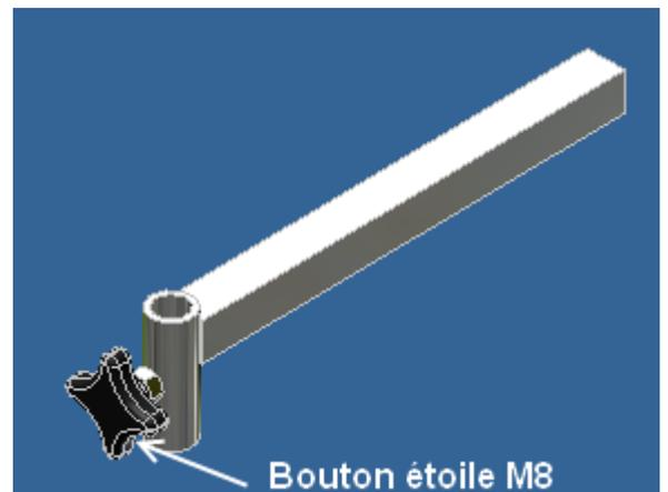
Les Etriers acier ou gouttière sont réglable en hauteur et en angle par serrage/dé-serrage Du bouton étoile M8 située sur le porte étrier :
