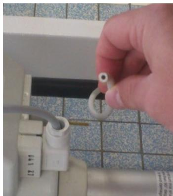
3/ Rebrancher le tuyau au moteur
