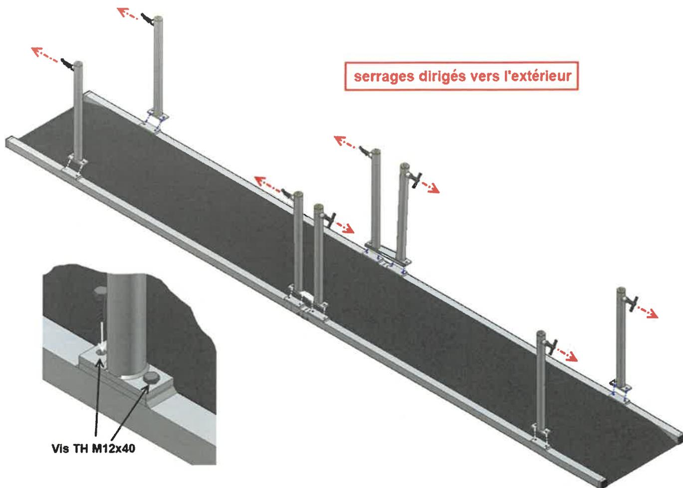
Pour le démontage, il suffit de dévisser les vis aux pieds des platines de poutre pour désolidariser les poutres du châssis.
