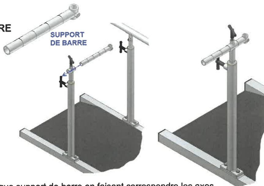
3.2.3 Présenter la barre parallèle sur chaque support de barre en faisant correspondre les axes support, puis fixer avec 2 vis BTR M10x16.
